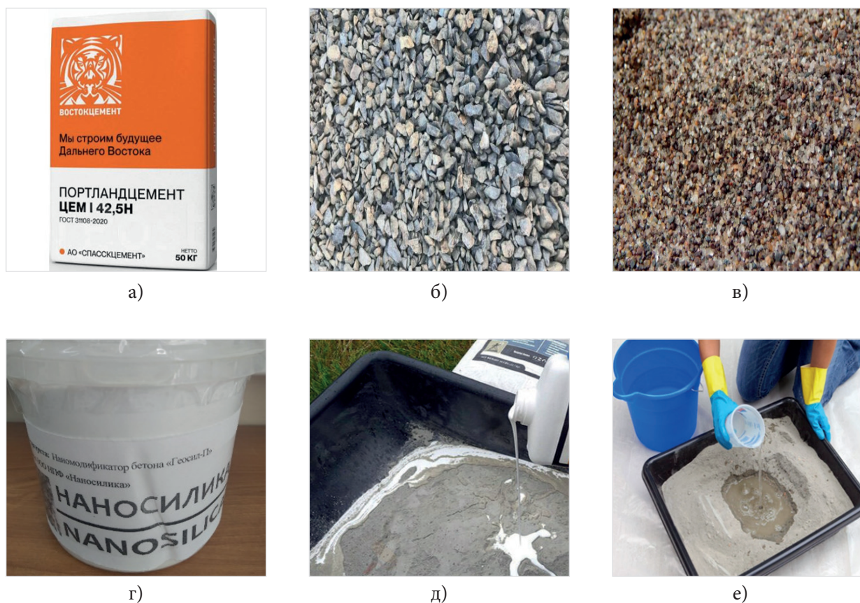
Рис. 1. Применяемые материалы: а) портландцемент ЦЕМ I 42,5Н; б) гранитный щебень фракции 5–20 мм; в) кварцевый песок смодулем крупности 2,4; г) гидротермальный нанокремнезём; д) поликарбоксилатный суперпластификатор «ХИДЕТАЛ-ГП-9 альфа А»; е) вода затворения
