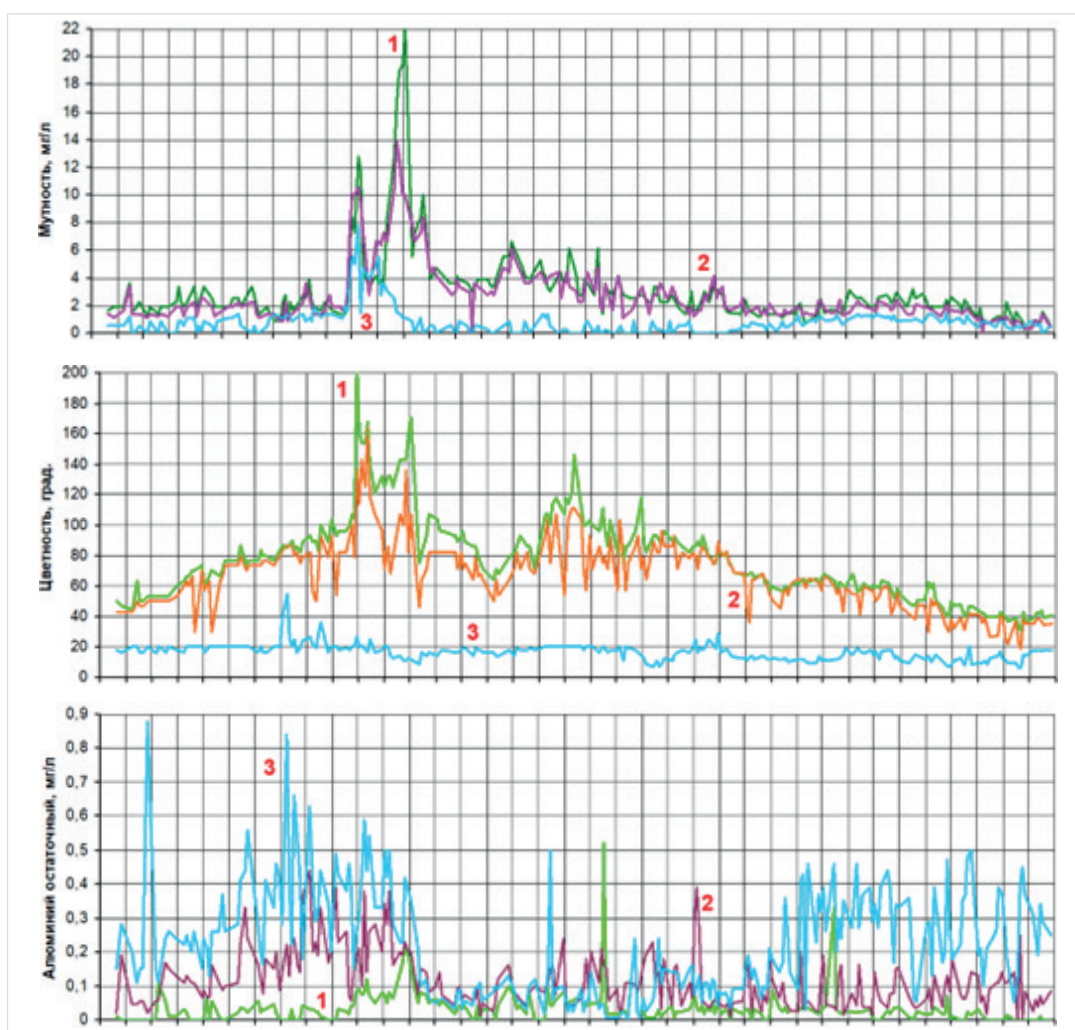
Рис. 3. Динамика изменения показателей качества воды (мутности, цветности и алюминия) в течение года по ступеням очистки: 1 — речная вода; 2 — осветленная воды; 3 — фильтрованная вода
