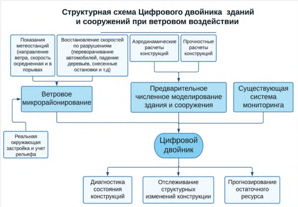
Рис. 4. Структурная блок-схема цифрового двойника зданий и сооружений при ветровом воздействии
