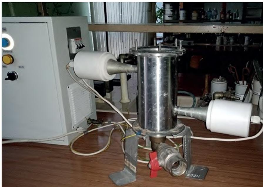
*Рис. 1.* Ультразвуковая ванна контактного типа с двумя излучателями
