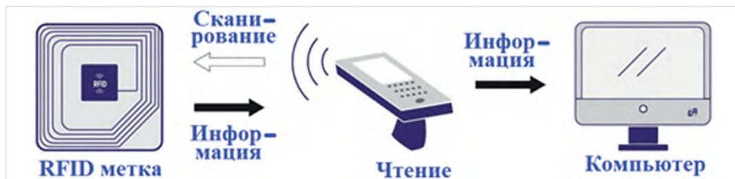
Рис. 3. Схема радиочастотной идентификации [7]
