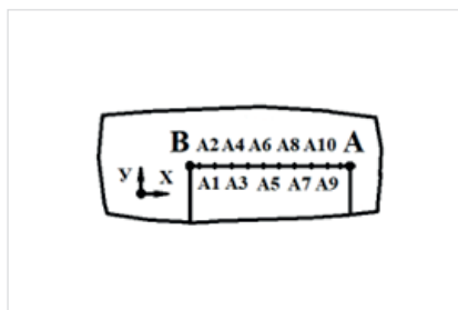
Рис. 7. Точки в которых получены контурные напряжения. Схема В. К. Мусаева
