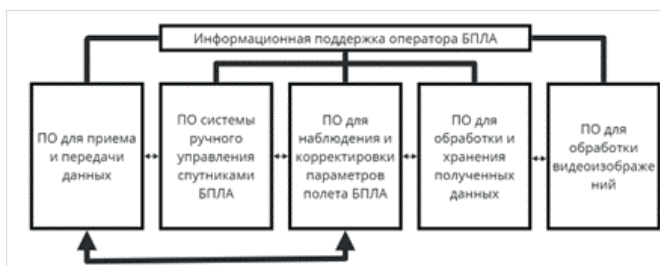
Рис. 1. Система информационной поддержки оператора БПЛА
