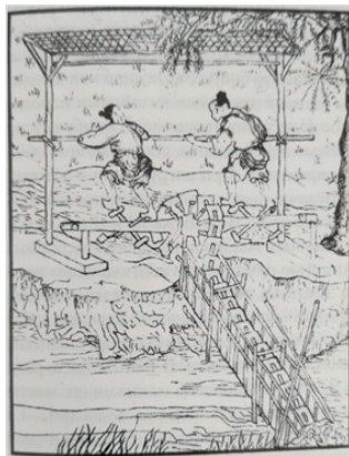
Рис. 1. Водоподъемное устройство «бесконечная цепь» (Древний Китай) с ручным приводом (Источники: Воронов Ю. В., Пугачев Е. А. История отрасли и введение в специальность «Водоснабжение и водоотведение»: учебник. — М.: Издательство АСВ, 2012. 392 с.)
